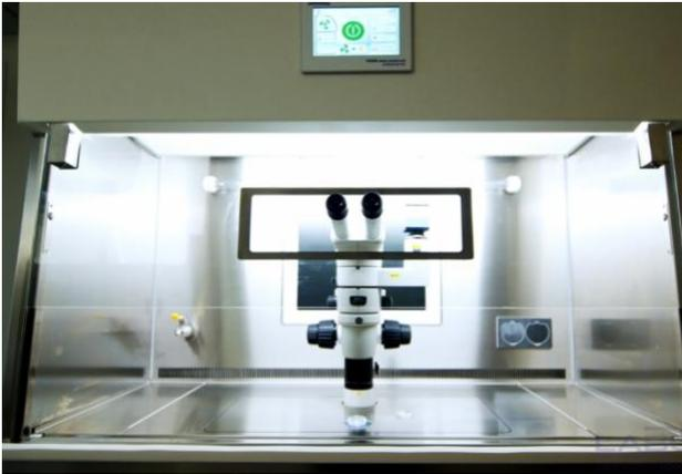
Nell'area di lavoro è installata un'efficiente lampada UV-C germicida. La forma e la posizione garantiscono una perfetta decontaminazione dell'area di lavoro senza interrompere il flusso d'aria laminare. La lampada è controllata da un touch screen, da un timer avanzato o da un telefono cellulare.
