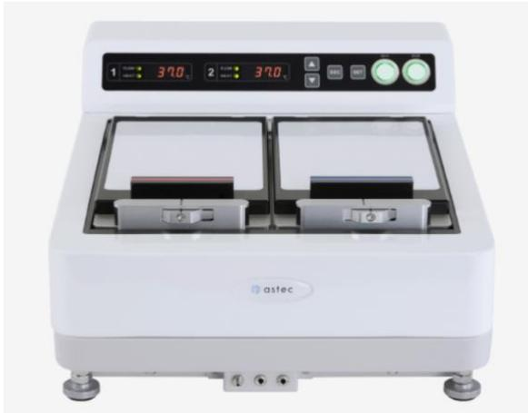
MINI offre una **maggiore versatilità** grazie alle sue dimensioni e alla compatibilità con i requisiti per una coltura cellulare di successo. Ogni camera è progettata per l'incubazione a **secco e umidificata**.
